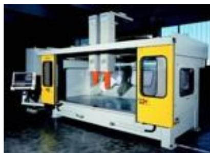
Комбинация оси Z с фрезерным шпинделем GEISS и второй осью Z с ультразвуковым ножом.
