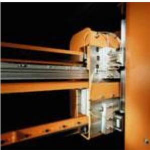
Современная техника систем управления с помощью Safety Integrated Sinumerik позволяет осуществлять управление данными приводами. Без применения данной системы управления мы считаем эксплуатацию линейных приводов безответственной, несмотря на надежность самих приводных механизмов.
